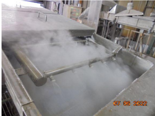
รูปที่ 1 ระบบสเปรย์น้ำที่ Diehead Vapour Absorber
